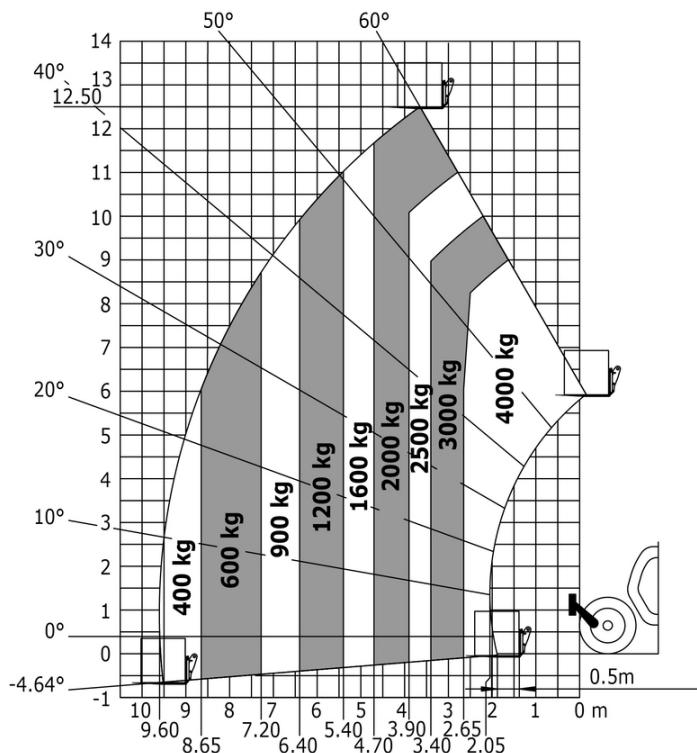
Drehung mit abgesenkten Stützen mit Gabeln
